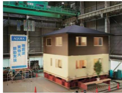
連続3回の震度7クラスの激震にも耐え、損傷なし。
